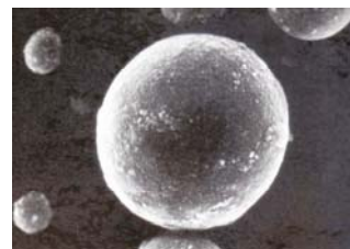
図17：多層構造の化粧品素材粒子
