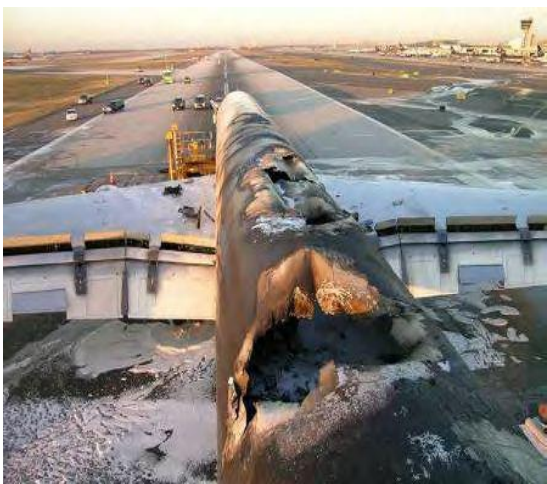
写真3 リチウムイオン電池の事故例 出所：米国エネルギー省 HP
