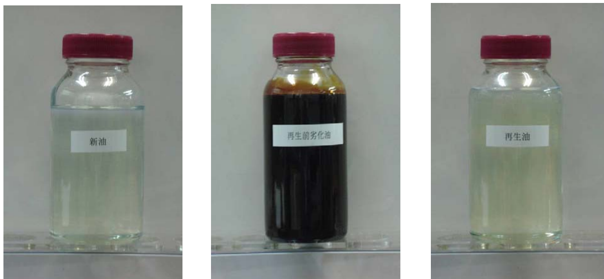
図5 熱媒の新油、再生前劣化油、再生油の比較
